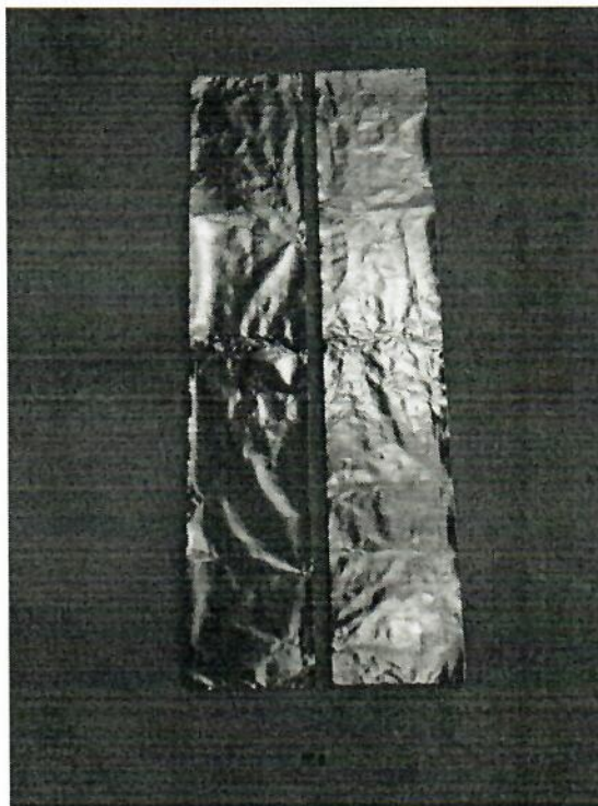
Вид образцов после испытания по ГОСТ 30244-94 (метод 2) с лицевой стороны материала - фольга
